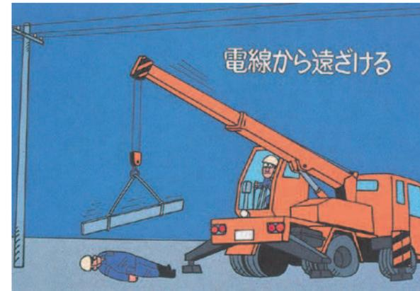
地上で操作するタイプの積載型トラッククレーンなどでは、オペレーターも感電する危険が高くなります。
